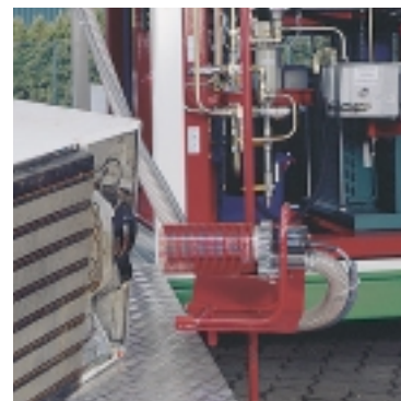
Séchoir à air chaud
